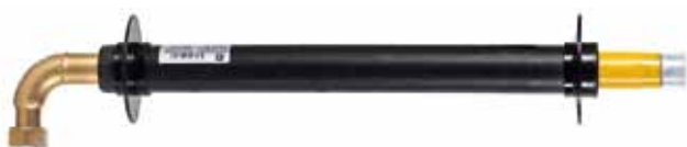
c Eelisolatsiooniga toru DN25, ülemutter 1", väliskeere 1", P = 650 mm, terastoru PE-kihiga
